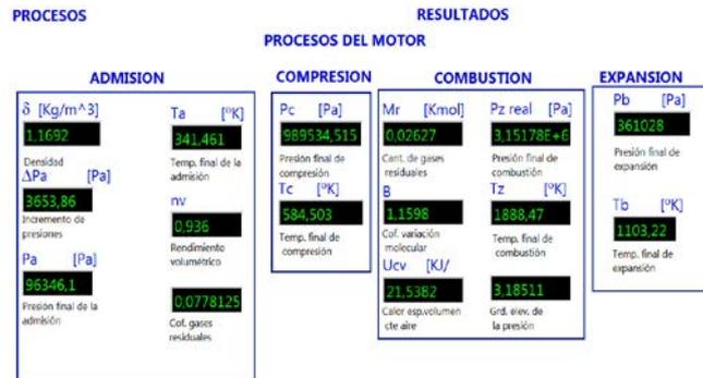
Figura 3. Resultados en la admisión, compresión y expansión en la pestaña 2
