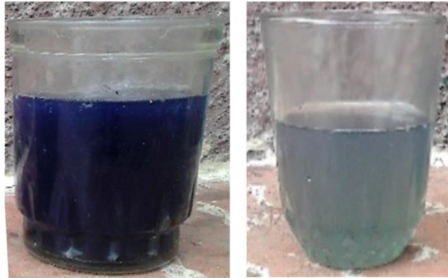
Figura 6. Resultados de filtración a través del prototipo. Se puede evidenciar la reducción del color en el efluente saliente.
