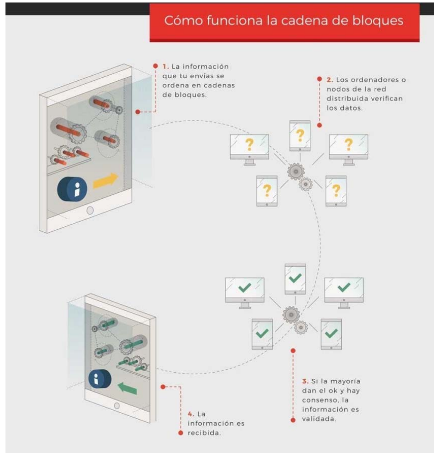
Figura 2. Funcionamiento de la cadena de bloques
