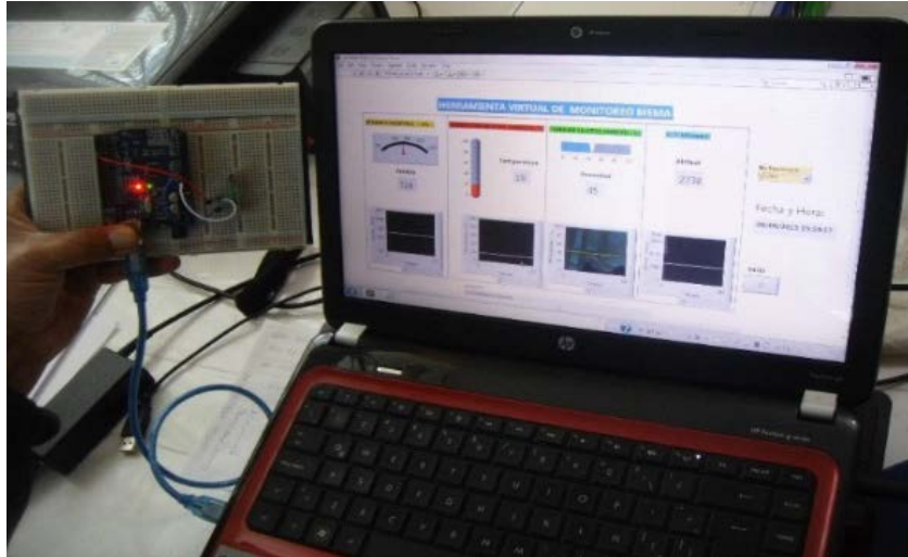
Figura 5. Pruebas de comunicación por el puerto USB entre el computador y el módulo receptor utilizando la herramienta virtual LabVIEW.
