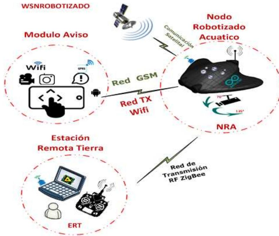
**Figura.1.** Arquitectura del WSN-ROBOTIZADO
