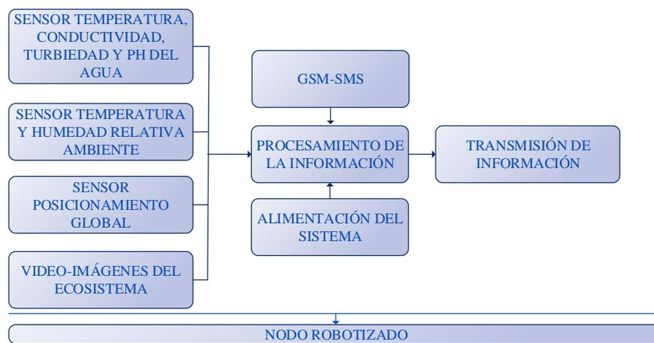
**Figura. 1. Diagrama de bloques del NRA.**
