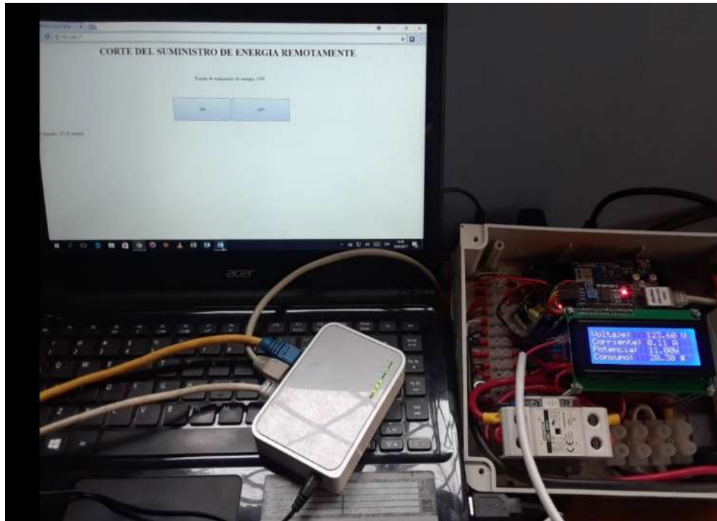
Figura. 8. Pruebas de comunicación bidireccional a través de Internet
